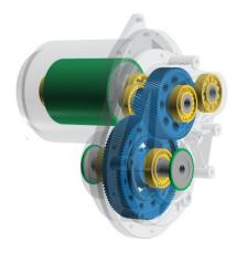
Il corpo ruota viene inoltre rappresentato nel calcolo dell'albero e nel calcolo di sistema con KISSsoft System Module.
