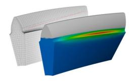
In KISSsoft è possibile effettuare un'analisi FEM 3D completamente integrata delle tensioni del piede del dente. Ai fini di un'efficiente integrazione in rete sono
