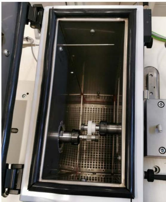
**Figura 3.** Cella climatica per test a temperature differenti
