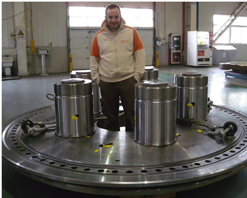
**Figura 4.** Versione ottimizzata prima del montaggio di cuscinetti e satelliti sui flexpin per un riduttore da 6 MW
