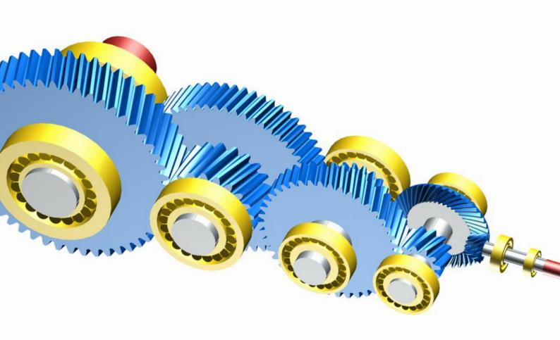
KISSsys ist ein Zusatzmodul zum Berechnungsprogramm KISSsoft. Mit KISSsys ist es möglich, das gesamte System aufzubauen und zu analysieren. Die Ergebnisse lassen sich dann in einer einzigen Berechnungsdatei abspeichern. Das Zusatzmodul erlaubt dem Bediener, die Vorteile von KISSsoft in KISSsys zu nutzen: das Programm verwaltet das Zusammenspiel der einzelnen Maschinenelemente, deren Lebensdauer und Festigkeit von KISSsoft errechnet und ins KISSsys übergeben werden.
