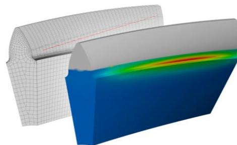
Con KISSsoft puede realizarse un análisis 3D de las tensiones en el pie del diente con un MEF integrado. Para un mallado más eficiente se han desarrollado
