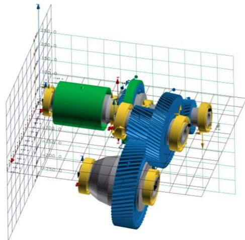
Se visualiza la deformación del sistema. Esto permite comprender los factores clave que provocan desplazamientos en la transmisión, por ejemplo, la flexión de árboles, cojinetes, cuerpos de la rueda o carcasas.
