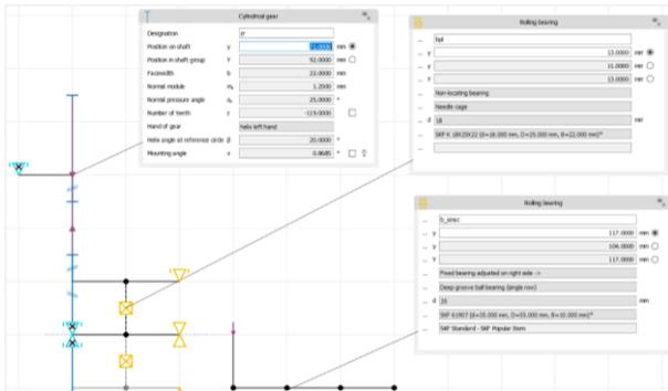
Las anotaciones ofrecen una rápida visión general de datos clave de los componentes como el número de dientes, el módulo, la longitud total del árbol o la denominación de un rodamiento. Esto simplifica la comunicación durante la revisión o al explicar un diseño.
