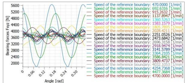
El análisis de vibraciones forzadas considera la excitación debido al error de transmisión en todos los engranes, desequilibrios de árboles y ondulaciones del momento torsor. Los ruidos de caja pueden calcularse mediante fuerzas de cojinete en función del tiempo.
