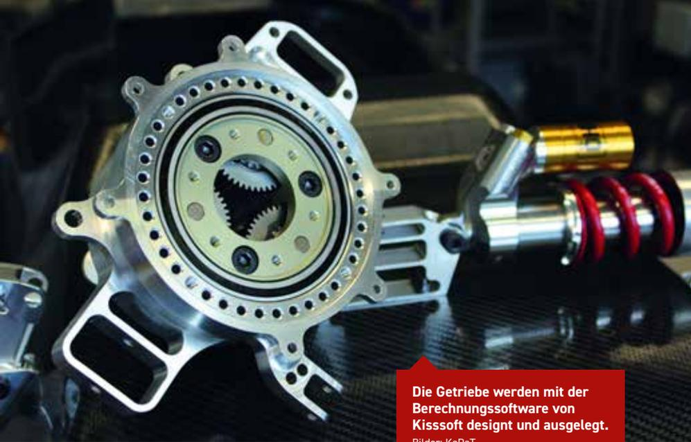
Die Getriebe werden mit der Berechnungssoftware von Kissoft designt und ausgelegt.
