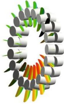
*Durch eine Berechnung gemäß ISO/TS 16281 lassen sich die Steifigkeit und die Nennlebensdauer eines Lagers präzise vorhersagen. Zu diesem Zweck wird die innere Geometrie eines Lagers modelliert und berücksichtigt.*
