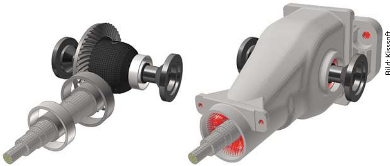
Abb. 3: Links: FEM-Modell des Antriebstranges. Rechts: FEM-Modell des Getriebes inklusive Gehäuse. Modell in Recur-Dyn, basierend auf KISSsoft-Daten.
