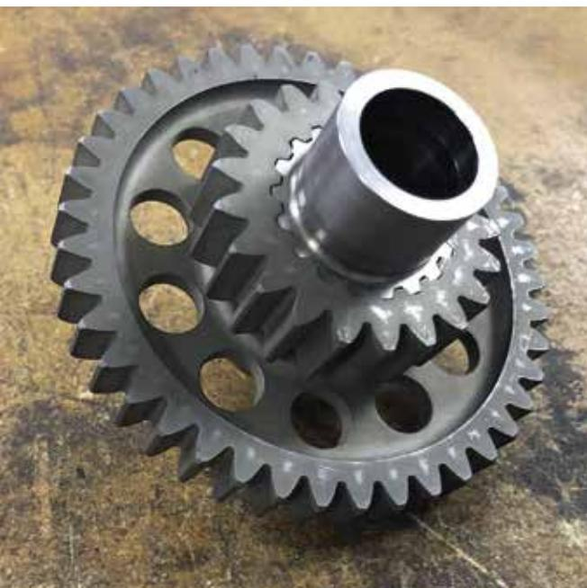
Die Zahnräder des 2019er-Fahrzeugs wurden für eine Lebensdauer von etwa 12 Stunden ausgelegt.
